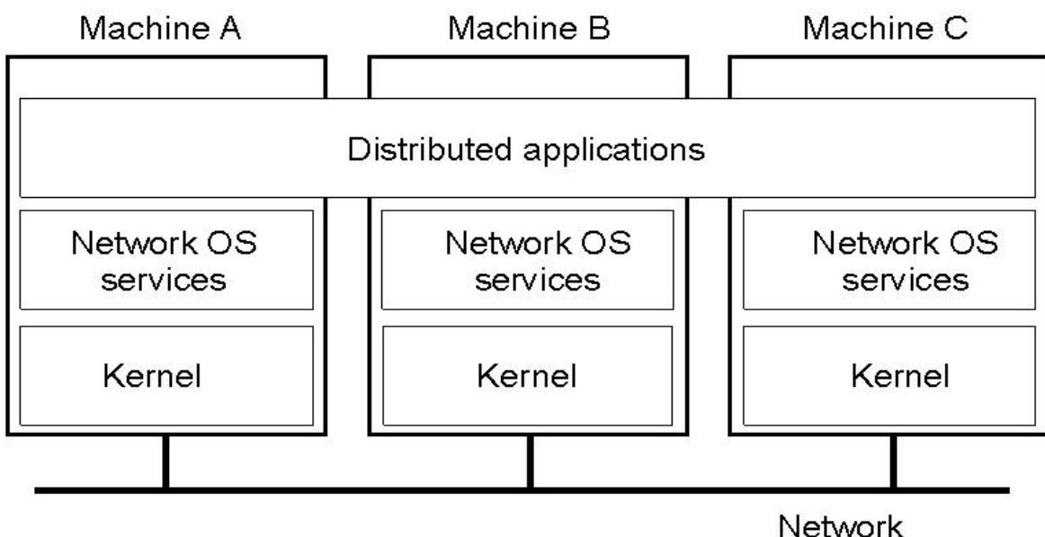
سه ماشین C, B, A به عنوان نمونه حضور دارند، این ماشین‌ها می‌توانند مشابه هم باشند که حالت‌های همگن را ایجاد کنند و یا غیر مشابه هم باشند که حالت غیرهمگن را ایجاد کنند و در واقع بر روی هر یک از اینها یک سیستم عامل شبکه وجود دارد که سرویس‌هایی را برای دیگران ارائه می‌دهد و Application‌های توزیع
