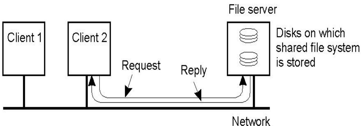
دقیق کنید File server خود یک ند از شبکه است که سرویس‌هایی را جهت استفاده دیگران از این سرویس‌ها آماده کرده است. این بحث را می‌توان برای هر یک از ند‌های موجود در شبکه مطرح نمود.
