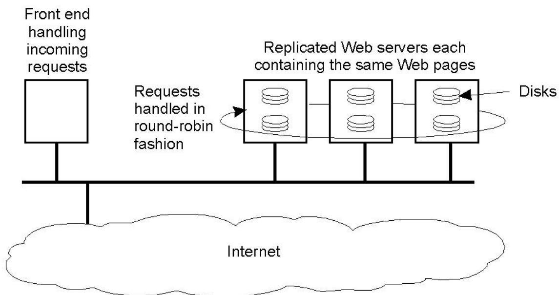
آنچه که در این شکل نشان داده شده است نمونه‌ای از یک سیستم مبتنی بر Web است که اصولاً یک معماری مسطح افقی دارد. در این شکل نشان داده شده است که Web server های تکرار شده متعددی که هر کدام دارای Web page های یکسانی هستند در سیستم قرار دارند و درخواست های بین این Web server ها به صورت Round robin مدیریت می شوند.
