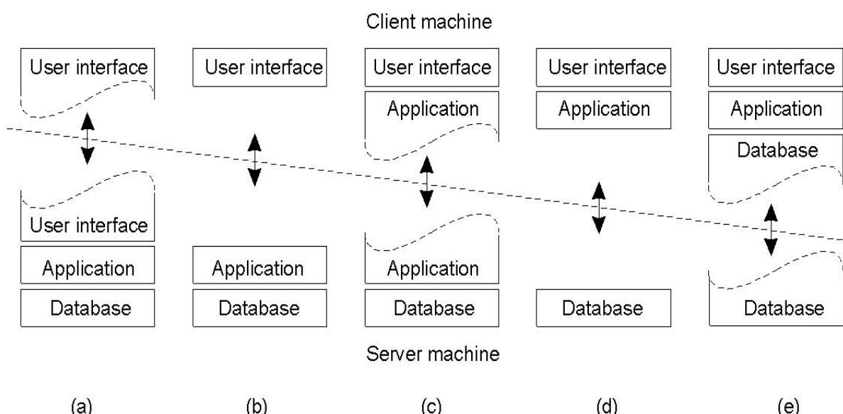
با توجه به شکل، معماری دو سطحی در واقع دارای دو سطح است، اما آنچه که جای اختلاف دارد این است که این دو سطح در کجا انقطاع بین دو سطح ایجاد می‌کند. به عبارت دیگر انقطعابین دو سطح یا اتصال بین دو سطح در کدام نقطه برقرار می‌شود. در شکل A می‌بینید که ممکن است در سطح بالایی، یک واسط کاربر و در سطح پائین نیز واسط کاربری حضور داشته باشد، به عبارت دیگر سطح اول و دوم و نقطه‌ی ارتباط سطح اول و دوم در بخش مربوط به واسط کاربر است.
