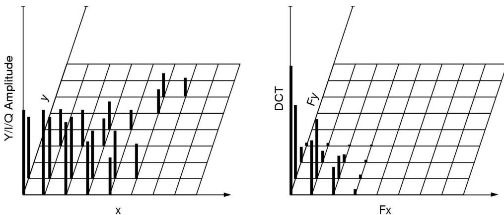
این مسئله در شکل نشان داده شده است. با توجه به شکل به دلیل خطاهای مربوط به Quantization عمل Quantized DCT به طور صدرصد برگشت پذیر نیست. پس از این کار در مرحله پنجم ضرایب DCT را می کنیم، بدین معنی که همه ضرایب DCT بر یک مقدار خاصی تقسیم می شود.
