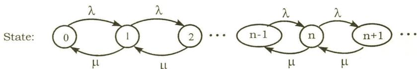
شکل ۴-۱ دیاگرام انتقال وضعیت مدل  $M/M/1$
