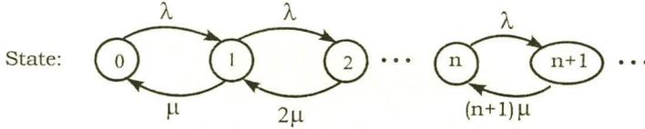
شکل ۴-۶ دیاگرام وضعیت انتقال مدل M/M/∞
