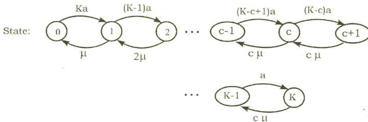
شکل ۴-۸ دیاگرام وضعیت انتقال مدل M/M/C/K/K
