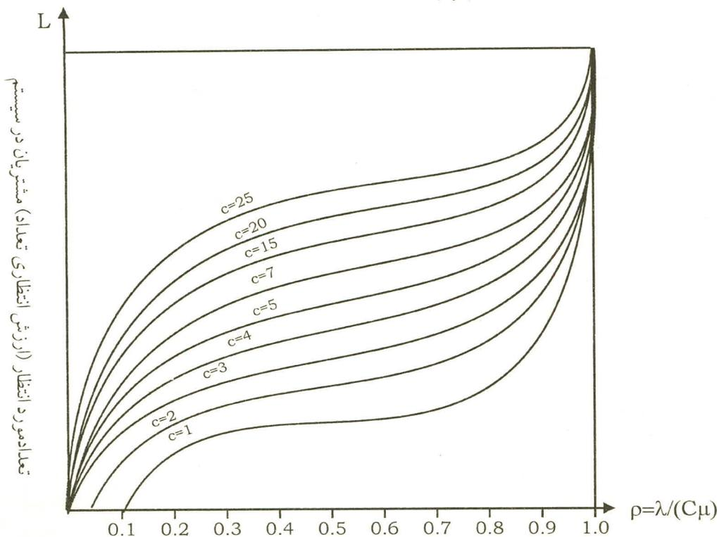
شکل ۴-۹ مقدار L بر حسب عامل استفاده در مدل صف، فرآیند ورودی بواسن و مدت خدمت ثابت
