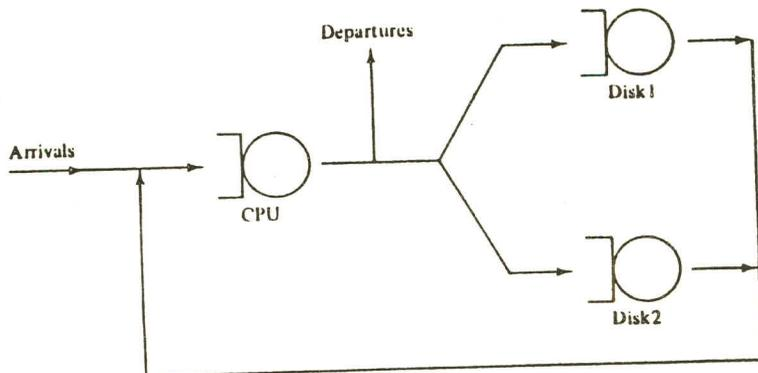
شکل ۸-۶ ساختار مدل باز
