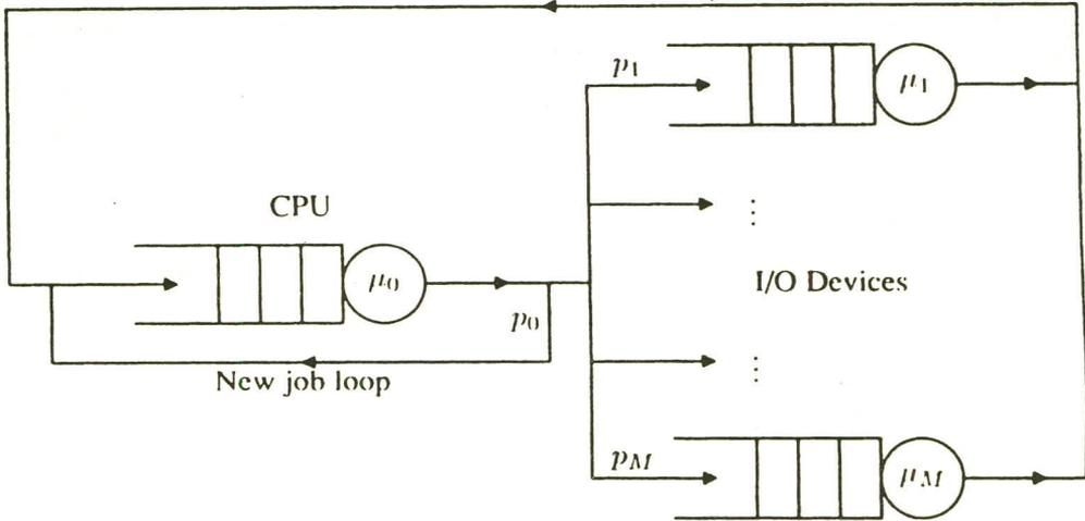
شکل ۵-۶ یک شبکه صفی بسته نمونه
