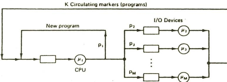
شکل ۳-۵ مدل سرویس دهنده مرکزی
