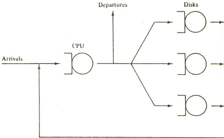
شکل ۶-۱ مدل شبکه صف از یک سیستم کامپیوتری با چندین سرویس دهنده
