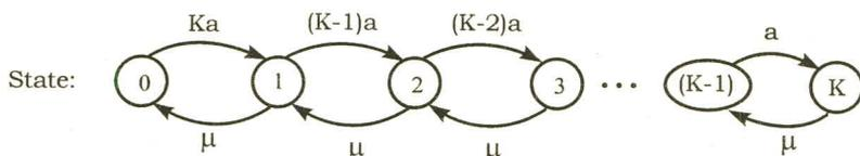
شکل ۴-۷ وضعیت انتقال مدل M/M/1/K/K
