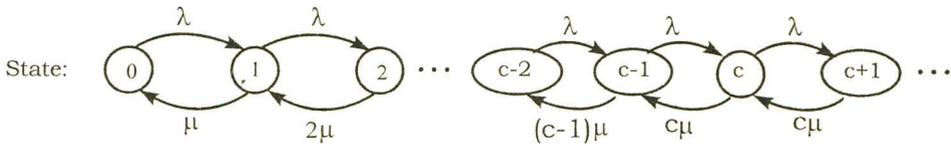
شکل ۴-۴ دیاگرام وضعیت انتقال مدل M/M/C
